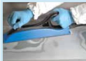
Для ручной шлифовки с целью выравнивания поверхности, обработанной полиэфирными материалами
