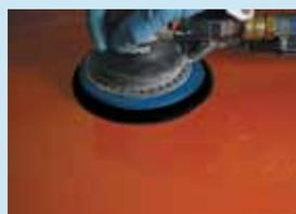
Для машинной шлифовки полиэфирных материалов и ЛКМ
