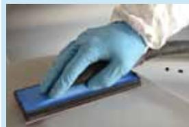
Для ручной шлифовки поверхностей с различной кривизной - от плоских до выпуклых/вогнутых
