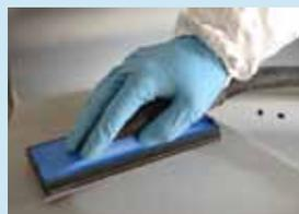
Для ручной шлифовки полиэфирных шпатлевок и грунтов-наполнителей при локальном ремонте
