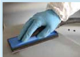
Применение с системой пылеотвода при работе с шлифовальными материалами
