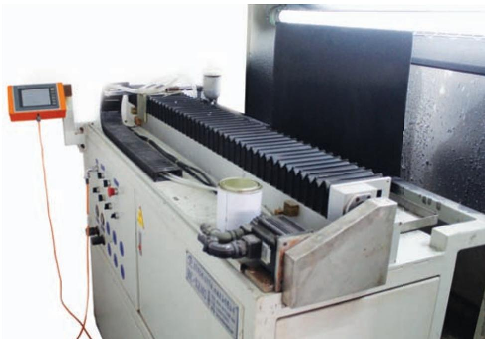
*Робот нанесения тест-напылов*
